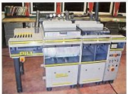
Projektentwicklung bei der Basista Leiterplatten GmbH - Optimierte chemische Entwicklungsanlage
